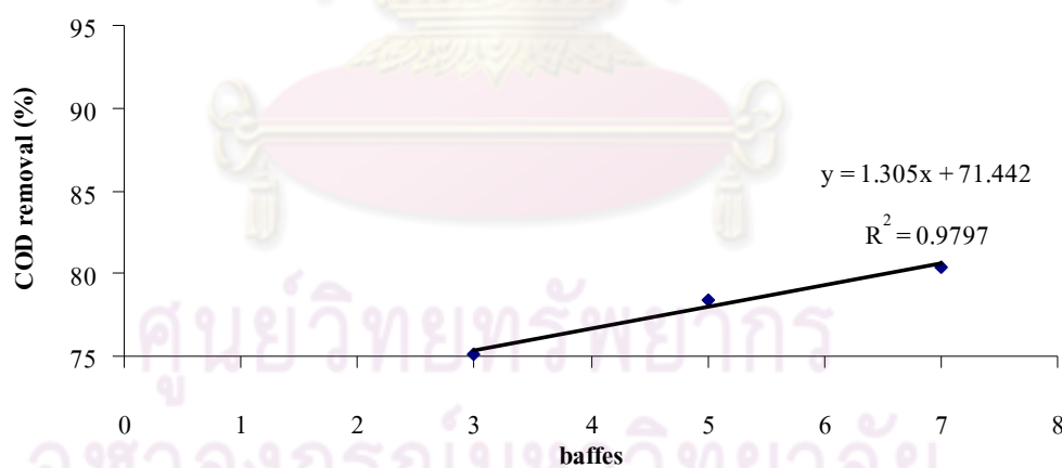
ภาพที่ 4.10 ความสัมพันธ์ระหว่างจำนวนแผ่นกั้นที่มีผลต่อประสิทธิภาพการบำบัดซีโอดีที่อัตราภาระบรทุกสารอินทรีย์เท่ากับ 3 กิโลกรัมซีโอดีต่อลูกบาศก์เมตร-วัน
