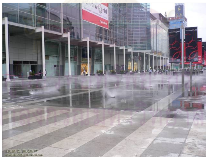
ภาพที่ 3.62 การใช้จุดพ่นละอองน้ำฝอย บนโซน B เพื่อจัดการความร้อน
