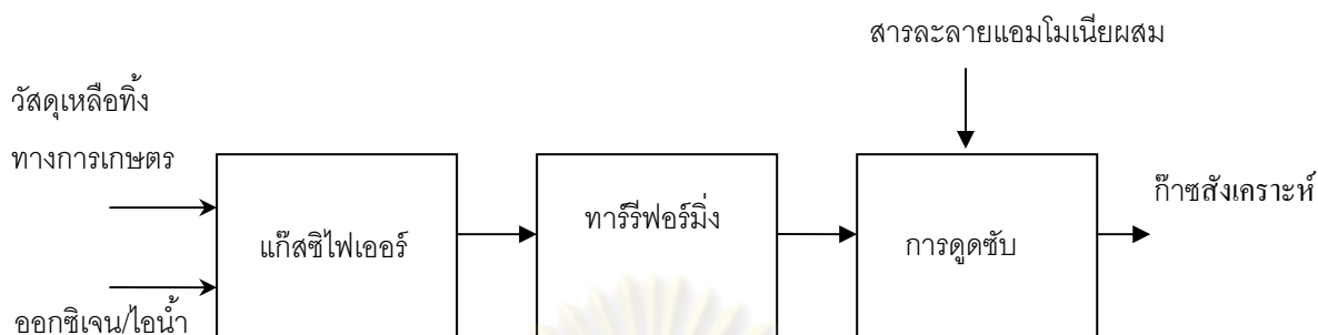
รูปที่ 2.1 แสดงขั้นตอนการทำแก๊สซิฟิเคชัน
