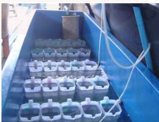
รูปที่ 3.6 ระบบที่ใช้ศึกษาระดับโปรตีนและไขมันที่เหมาะสมในอาหารสำหรับหอยเป่าฮือ H. asinina
