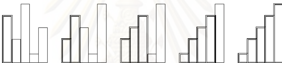
รูปที่ 2.2 การทำงานของการเรียงลำดับแบบแทรก
