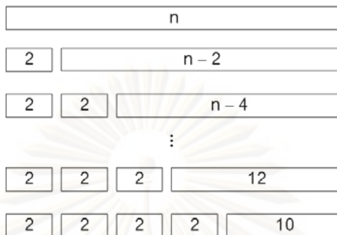
รูปที่ 3.8 การทำงานของควิกซอร์ตด้วยตัวประชิดตัวหลักในกรณีแย่ที่สุด
