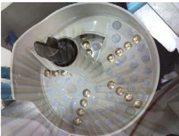
รูปที่ 5 ตะกร้าชุบชิ้นงานที่ใช้ในกระบวนการชุบ
