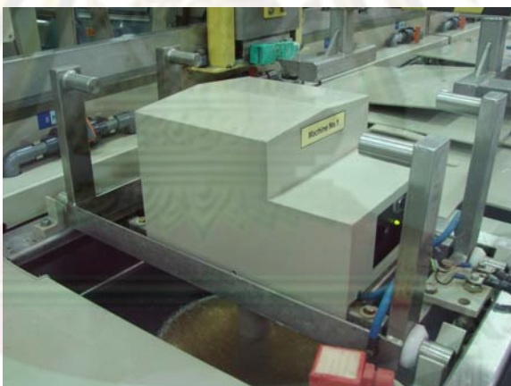
รูปที่ 3.5 ลักษณะการชุบชิ้นงานด้วยเครื่องสั่น(Vibrator)
