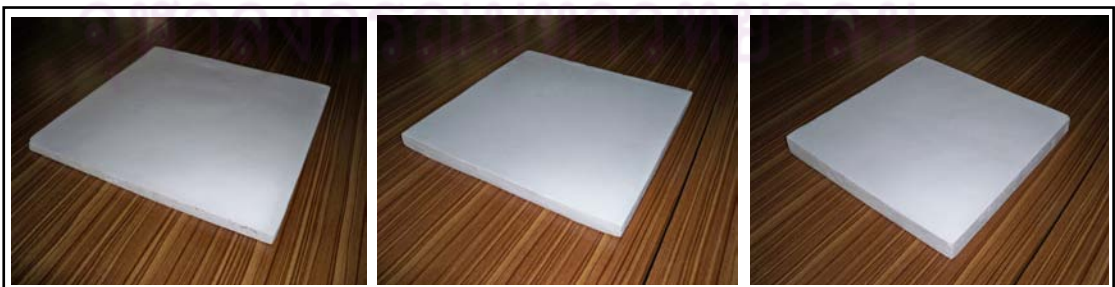
รูปที่ 4.1 แผ่นฝ้าเพดานจากฟางข้าวผสมมะพร้าวสับ ขนาด 30 ซม. x 30 ซม.
