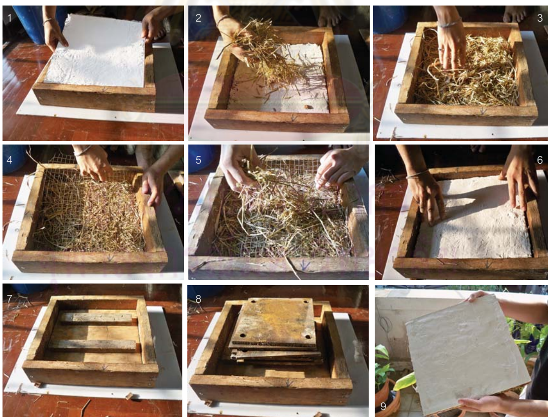
รูปที่ 3.8 ขั้นตอนการผลิตแผ่นวัสดุด้วยวิธีการอัด ขนาด 30x30 ซม.
