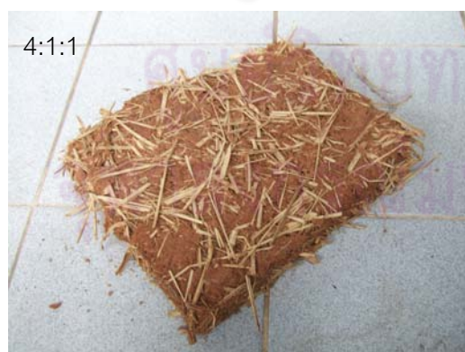
รูปที่ 3.11 แสดงผลการขึ้นรูปในอัตราส่วนต่าง เช่น 2 : 1 : 1, 4 : 1 : 1 และ 5 : 1 : 1
