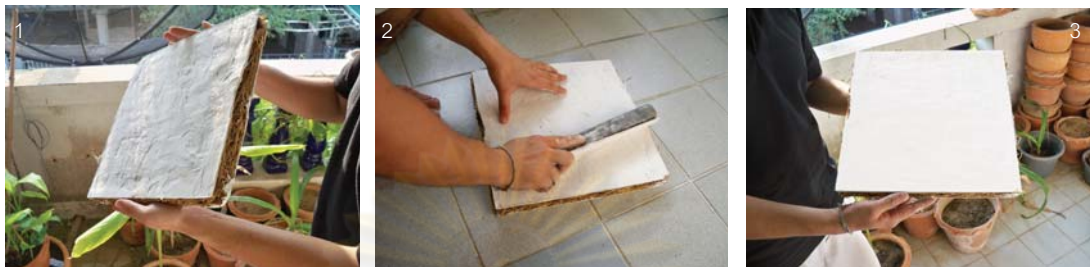
รูปที่ 3.9 ขั้นตอนการขัดและเก็บรายละเอียดของแผ่นวัสดุ ขนาด 30x30 ซม.
