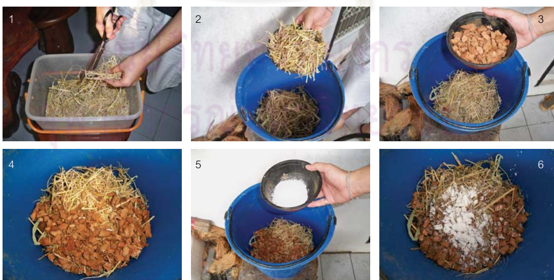
รูปที่ 3.6 ขั้นตอนการผสมฟางข้าวกับมะพร้าวสับเพื่อทำเป็นแผ่นวัสดุประกอบอาคารจากวัสดุเหลือใช้ทางการเกษตร
