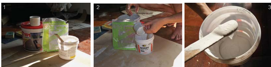
รูปที่ 3.4 ขั้นตอนการผสมปูนยิปซัมกับน้ำยาผสมปูนยิปซัมเพื่อทำเป็นแผ่นประกบกับวัสดุประกอบอาคารจากวัสดุเหลือใช้ทางการเกษตร
