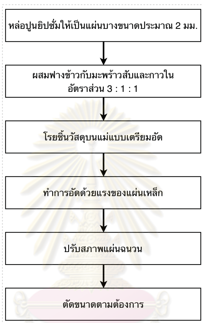
รูปที่ 3.12 ขั้นตอนการผลิตแผ่นฝ้าเพดานจากฟางข้าวผสมมะพร้าวสับ
