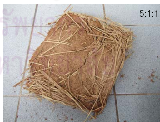
รูปที่ 3.11 แสดงผลการขึ้นรูปในอัตราส่วนต่าง เช่น 2 : 1 : 1, 4 : 1 : 1 และ 5 : 1 : 1
