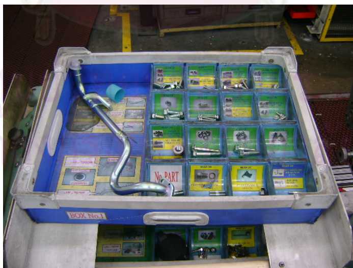
รูปที่ 5.4 การปรับปรุงกล่องจัดส่งชิ้นส่วนให้สามารถ Visualize Check
