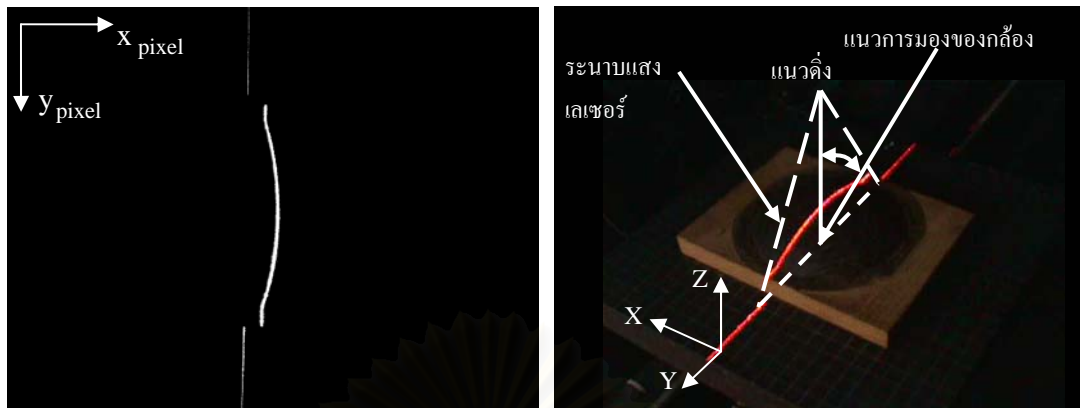
รูปที่ 5.1 ลักษณะการเกิดภาพบนกล้อง CCD
