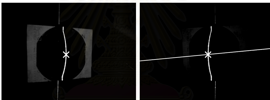
รูปที่ 3.13 จุดของภาพที่ตรงกันในภาพซ้ายและขวาที่ได้จากจุดตัด ของเส้นเลเซอร์และ epipolar line
