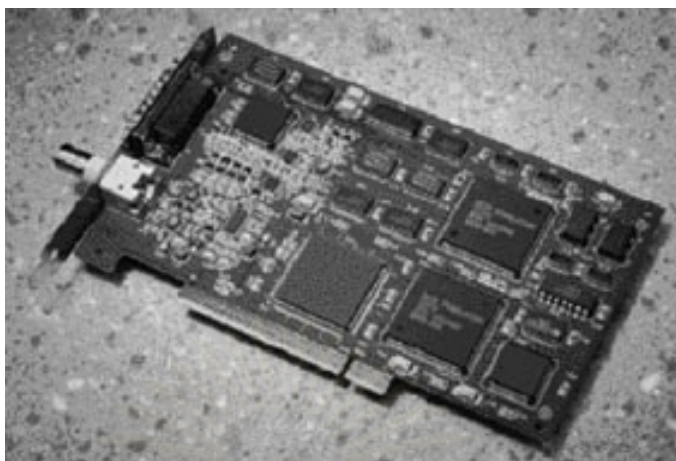
รูปที่ ข.9 การ์ดประมวลผลภาพรุ่น DT3155 ของบริษัท Data Translation จำกัด
