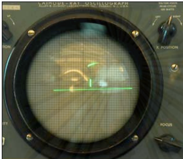
ภาพที่ 4.5 Oscilloscope อุปกรณ์ในห้องวิจัยที่ถูกนำมาใช้เล่นเกมเทนนิส
