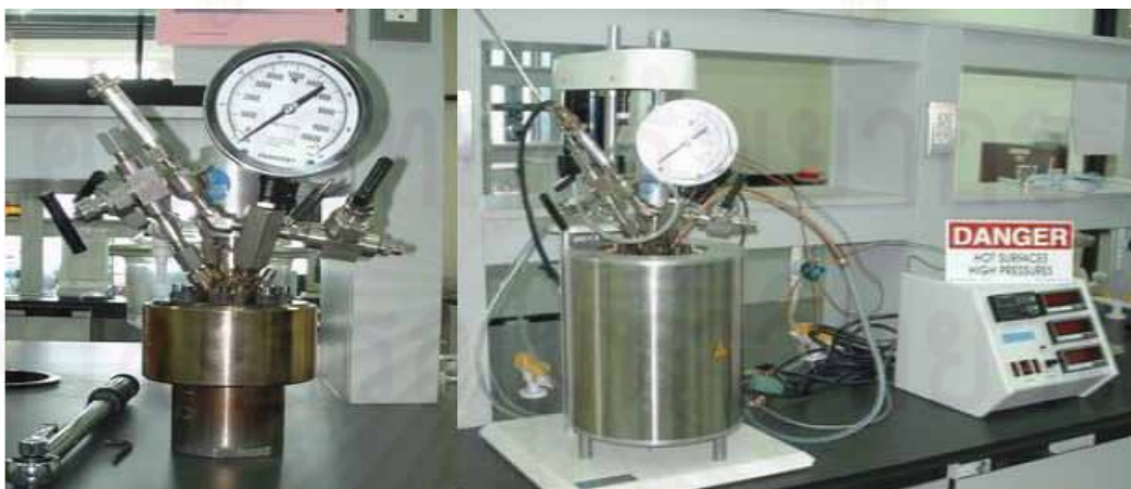
รูปที่ 3.1 เครื่องปฏิกรณ์ Parr Reactor Model 4843
