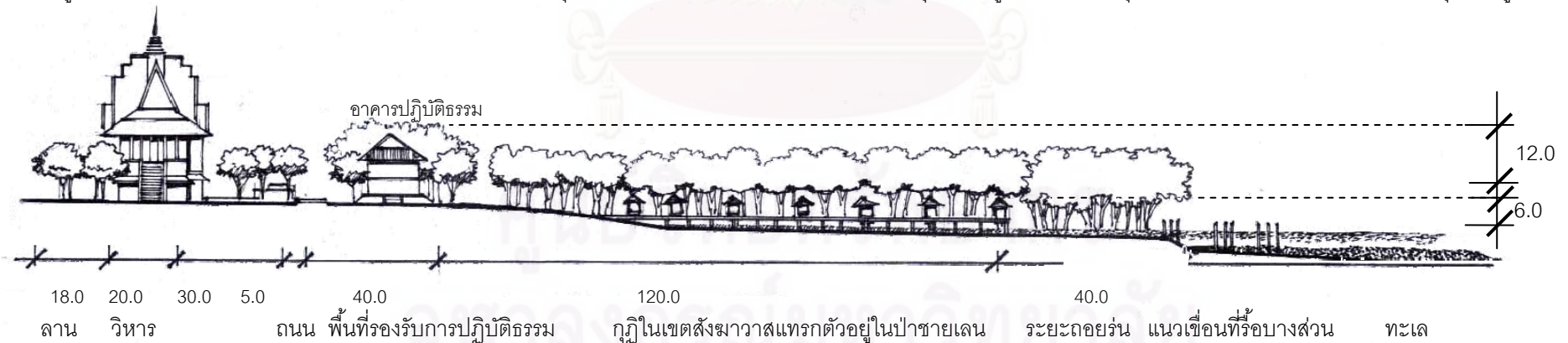
รูปที่ 7.13 ภาพตัด จากทิศเหนือ-ทิศใต้ ถึงแนวชายฝั่งทะเล แสดงแนวความคิดการควบคุมความสูงและการจัดกลุ่มของอาคาร
