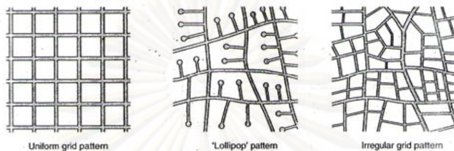
ภาพที่ 2-2 แสดงรูปแบบของถนนแบบต่างๆ
