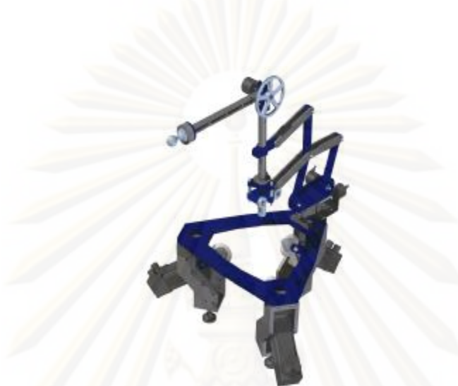
รูปที่ 3.8 ชุดแขนกล ชุดจับยึด และระบบส่งกำลังที่ต่อเข้ากับฐานของหุ่นยนต์
