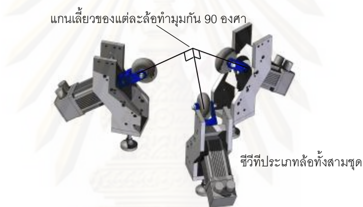
รูปที่ 3.3 ซีวีทีที่ประเภทล้อจำนวน 3 ชุด ถูกจัดวางทำมุมกัน 90 องศา
