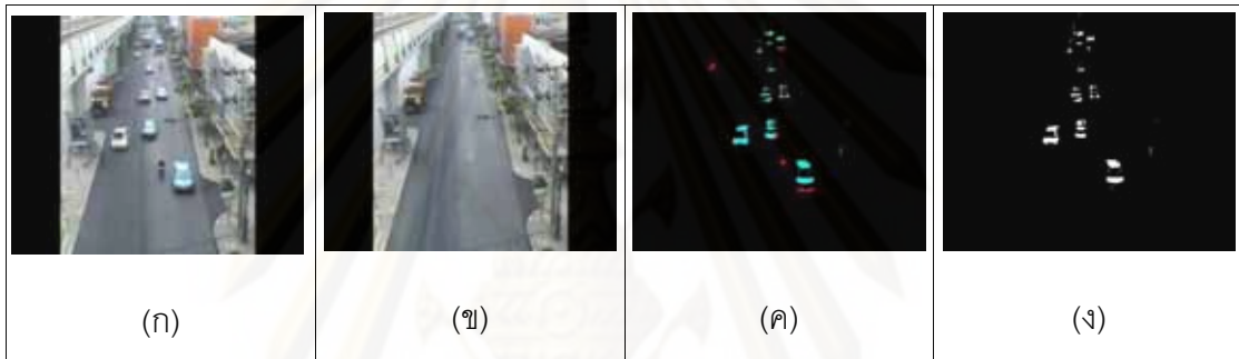
รูปที่ 2.5 ผลการทดลองกับวิถีทัศนัวจราจรกรณีทั่วไป (ก) ภาพขาเข้าปัจจุบัน (ข) ภาพฉากหลังที่สร้างขึ้น (ค) ภาพผลจากการแยกประเภทจุดภาพ (ง) ภาพผลการลบฉากหลัง
