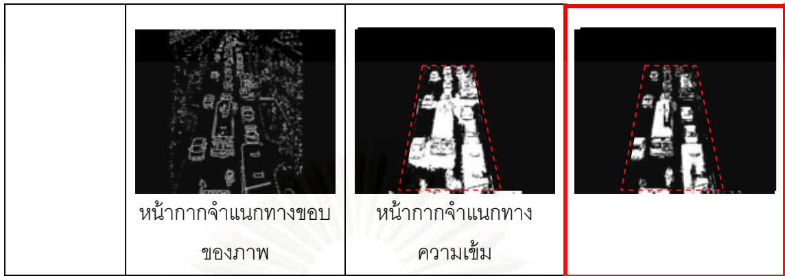
ตารางที่ 4.4 เปรียบเทียบผลการลบฉากหลังด้วยวิธีต่างๆ สำหรับกรณีวีดิทัศน์จราจรติดขัดและมีรถประจำทางจอดเป็นเวลานาน
