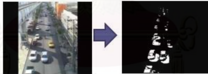
รูปที่ 1.7 การตรวจจับวัตถุจากหน้าผิดพลาดเนื่องจากเงาของวัตถุ
