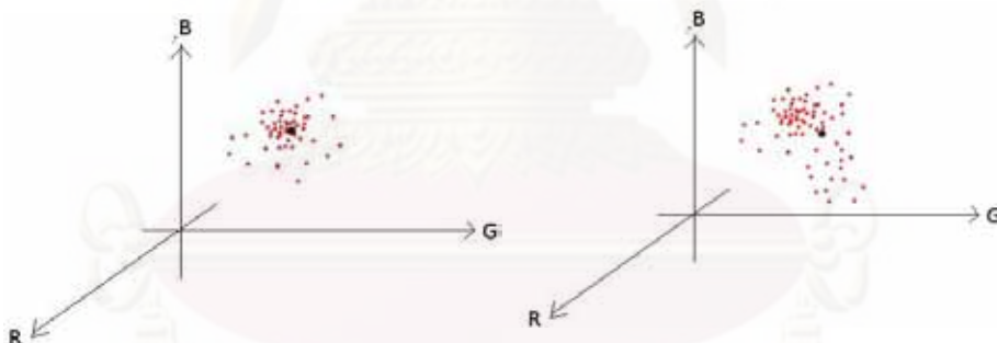
รูปที่ 2.8 แสดงชุดข้อมูลบนปริภูมิ RGB โดยจุดสีดำ คือค่าเฉลี่ยของตัวอย่างทั้งหมด ภาพซ้ายจะแสดงกรณีที่ข้อมูลมีการกระจายตัวปกติ ภาพขวาแสดงกรณีที่ข้อมูลกระจายตัวผิดปกติ
