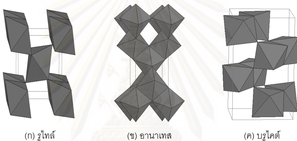
รูปที่ 2.13 ลักษณะโครงสร้างผลึกของไทเทเนียมไดออกไซด์ [32]
