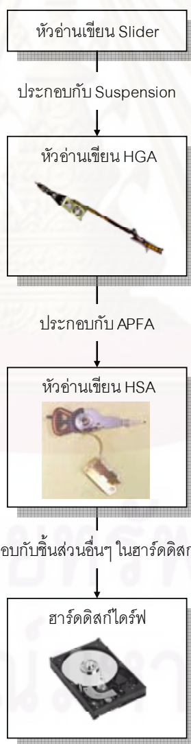
รูปที่ 3.1 ขั้นตอนในการผลิตจากหัวอ่านเขียนไปเป็นฮาร์ดดิสก์ไดรฟ์
