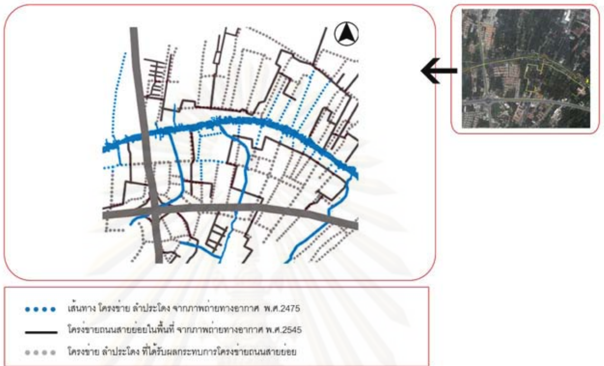
ภาพ 4-12 โครงข่ายลำประโดงที่ถูกทำลายจากการที่เส้นทางตัดผ่านและถล่มลงบนลำประโดง
