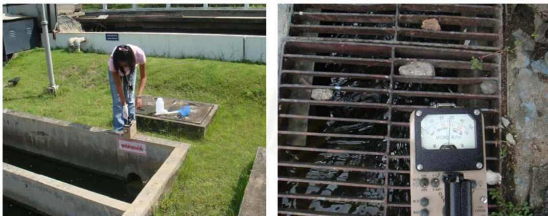
รูปที่ 3.4 การตรวจวัดระดับรังสีด้วยเครื่องสำรวจรังสี (survey meter)
