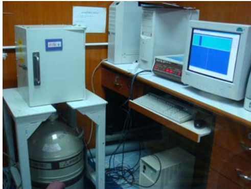
รูปที่ 3.2 การวิเคราะห์หาปริมาณรังสีแกมมา ด้วยเครื่องแกมมา สเปคโตรเมตรี
