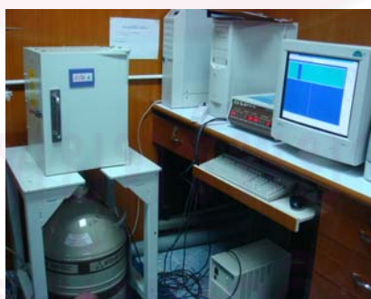
เครื่องตรวจวัดรังสีแกมมาแบบแยกพลังงาน ยี่ห้อ EG&G ORTECT รุ่น 232P
