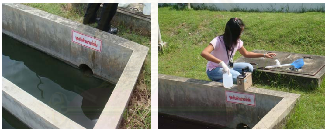
รูปที่ 3.1 แสดงการเก็บตัวอย่างที่จุดเก็บตัวอย่างน้ำทิ้ง ก่อนปล่อยสู่สาธารณชน
