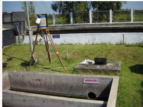
รูปที่ 3.3 การวิเคราะห์หานิวไคลด์รังสีบริเวณบ่อบำบัดน้ำทิ้ง โดยเครื่องวัดรังสีแบบหลายช่องพลังงานชนิดเคลื่อนย้ายได้
