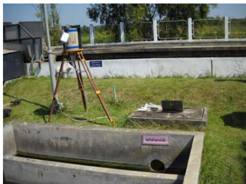
เครื่องวัดรังสีแกมมาแบบแยกพลังงานชนิดพกพา ยี่ห้อ Canberra รุ่น Inspector 2000
