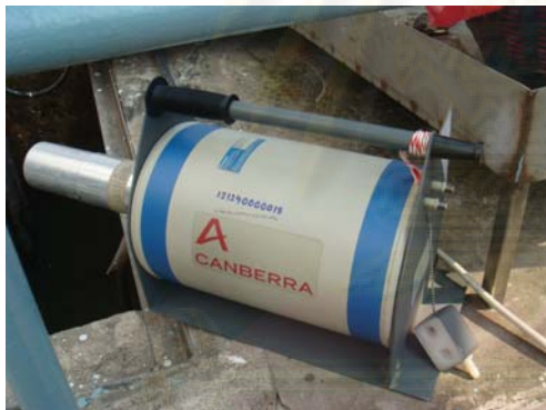
รูปที่ 3.3 การวิเคราะห์หานิวไคลด์รังสีบริเวณบ่อบำบัดน้ำทิ้ง โดยเครื่องวัดรังสีแบบหลายช่องพลังงานชนิดเคลื่อนย้ายได้
