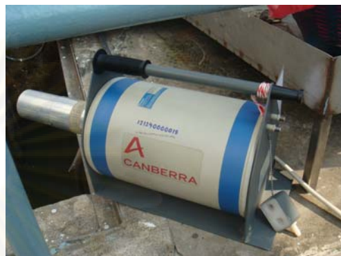
เครื่องวัดรังสีแกมมาแบบแยกพลังงานชนิดพกพา ยี่ห้อ Canberra รุ่น Inspector 2000
