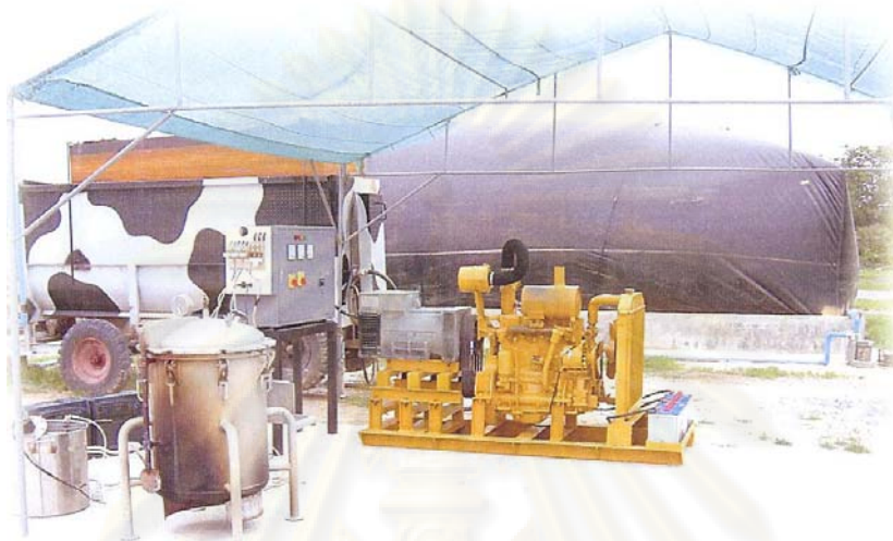
รูปที่ 4.6 ทดสอบเครื่องยนต์ดีเซล เชื้อเพลิงด้วยฮีตเตอร์
