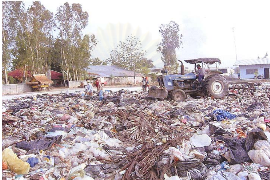
รูปที่ 3.9 เปิดปากถุงขยะโดยใช้เครื่องจักรกล
