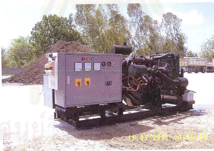
รูปที่ 3.15 เครื่องยนต์ดีเซล ISUZU ดัดแปลงขนาด 6 สูบ 5,785 ซีซี
