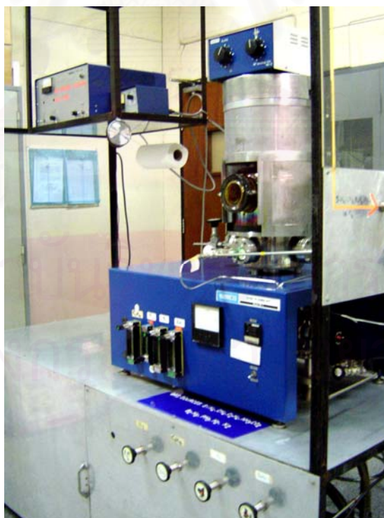
รูปที่ 3.7 ระบบ Glow Discharge Plasma CVD ที่ใช้ในงานวิทยานิพนธ์
