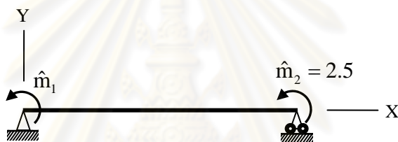
รูปที่ 6.62 คานที่มีฐานรองรับอย่างง่ายรับโมเมนต์กระทำคงที่ที่ปลายด้านขวา และรับโมเมนต์กระทำใดๆที่ปลายด้านซ้าย
