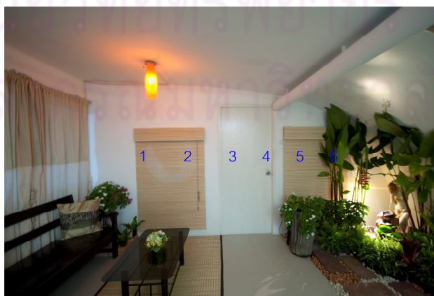
รูปที่ 3.21 แสดงผังการวัดอุณหภูมิเฉลี่ยพื้นผิวผนังบริเวณช่องแสงและการวัดแสงจากผนัง
