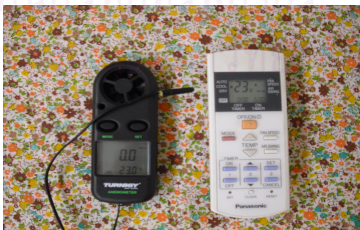
รูปที่ 3.24 แสดงการวัดความเร็วลมบนพื้นที่การใช้งานในห้องนวดสปาต้นแบบ
