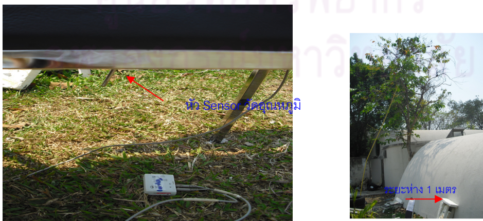
รูปที่ 3.14 แสดงการติดตั้งหัววัดอุณหภูมิที่บริเวณภายนอกห้องนวดสปาต้นแบบ
