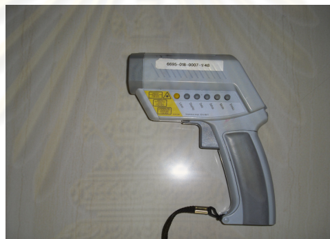
รูปที่ 3.4 รูปเครื่องวัดอุณหภูมิเทอร์โมมิเตอร์แบบอินฟราเรด Testo 860-T2
