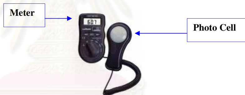
รูปที่ 3.8 แสดงส่วนประกอบของเครื่องมือวัดความเข้มของแสงสว่าง DX-200
