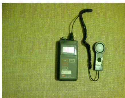
รูปที่ 3.7 รูปเครื่องมือวัดความเข้มของแสงสว่าง DX-200
