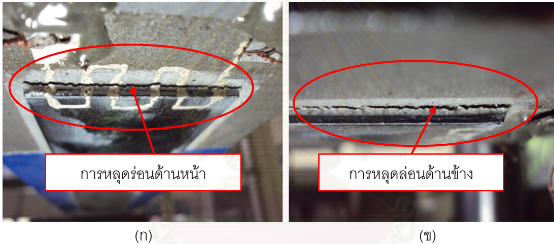
รูปที่ 7.1 การหลุดล่อนที่เกิดขึ้นระหว่างผิวสัมผัสของผิวเหล็กกับวัสดุประสาน (BSC602S) (ก) ด้านหน้าของปลายแผ่น และ (ข) ด้านข้างของปลายแผ่น
