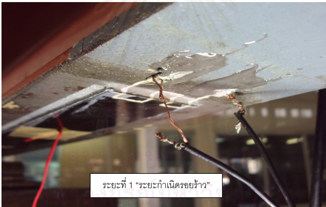
รูปที่ 5.2 การทดลองคานเหล็กที่เสริมกำลังด้วยแผ่นพลาสติกเสริมเส้นใยคาร์บอนภายใต้แรงกระทำเป็นรอบแอมพลิจูดคงที่ในระยะก่าเนตรอยร้าว (รอยร้าวไม่เกิดขึ้น, BSC901S, จำนวนรอบของแรงกระทำประมาณ 500 รอบ)
