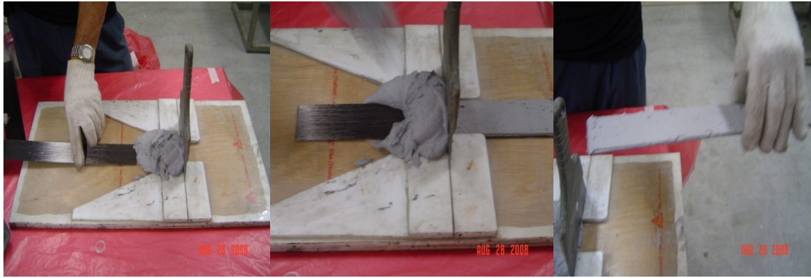
รูปที่ 4.3 ขั้นตอนการทาวัดดูประสานเข้ากับแผ่นพลาสติกเสริมเส้นใยคาร์บอน
