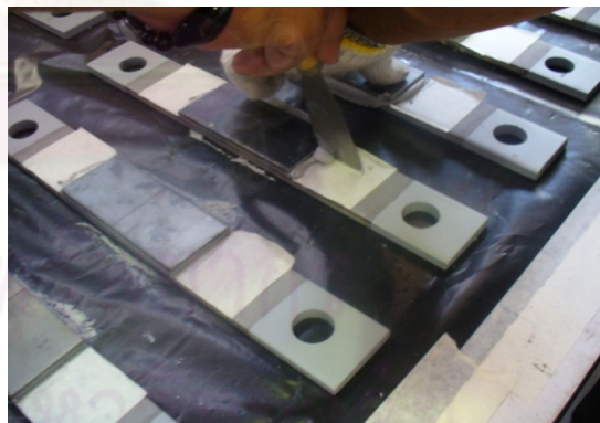
(ข) ควบคุมมุมของชั้นวัสดุเชื่อมประสาน ให้ตั้งฉากกับแผ่นเหล็ก
