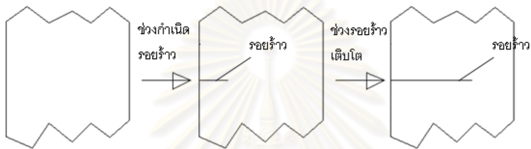
รูปที่ 3.7 กระบวนการเกิดความเสียหายล้า (จิรพงศ์ กสิวิทย์อำนาจ, 2553)
