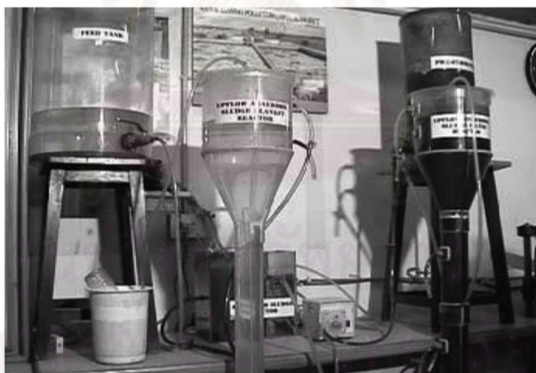
รูปที่ 2.12 แสดงลักษณะของอุปกรณ์แยกสามสถานะในระบบยูเอเอสพี (Yasar และคณะ ,2006
