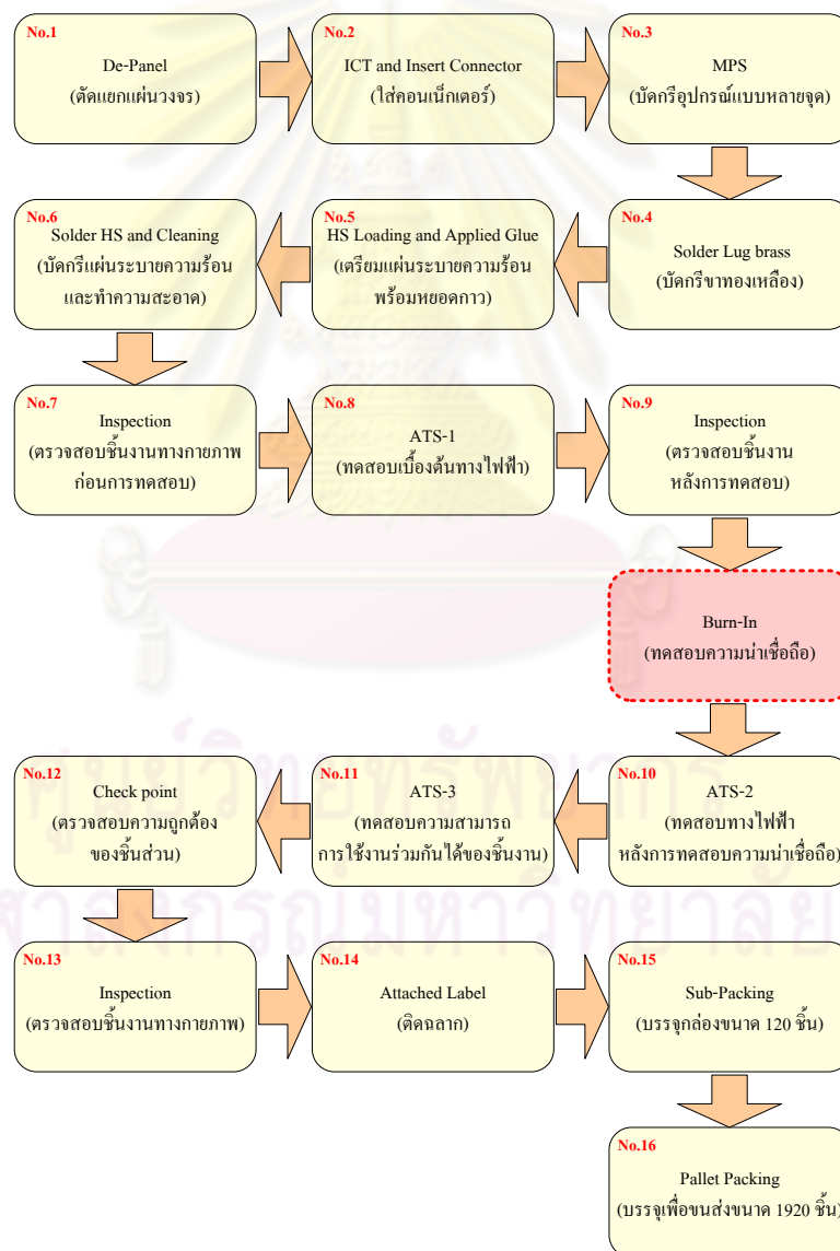
รูปที่ 3.11 กระบวนการผลิตของผลิตภัณฑ์รุ่น D12S0530-1 C แยกตามสถานีงาน
