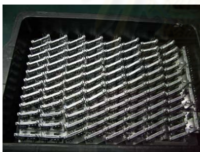
รูปที่ 4.10 ถาดและการขนย้าย ตัวอุปกรณ์เข้าสู่สายการผลิต
