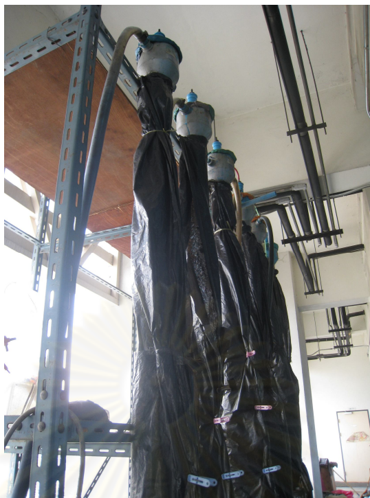
ภาพที่ 3.7 ลักษณะการติดตั้งระบบยูเอเอสบี
