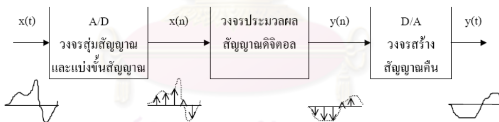
รูปที่ 10 ส่วนประกอบในระบบประมวลผลสัญญาณดิจิทัล
