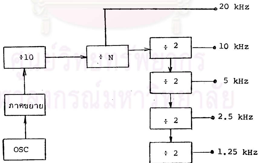
รูปที่ 3.2.3 แสดงบล็อกไดอะแกรมของวงจรหารความถี่
