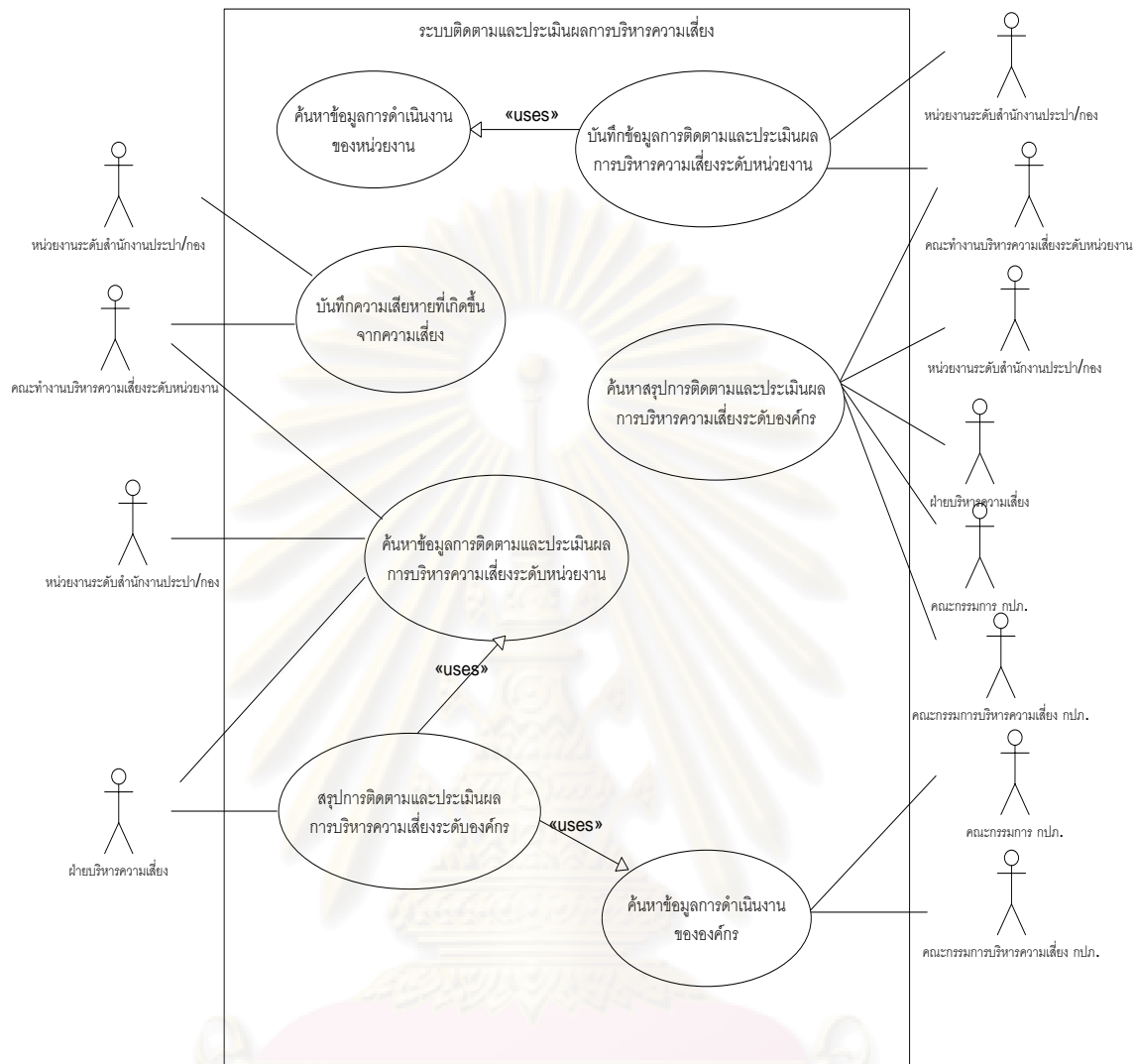
รูปที่ 4.3 แผนภาพยูสเคส ระบบติดตามและประเมินผลการบริหารความเสี่ยง
