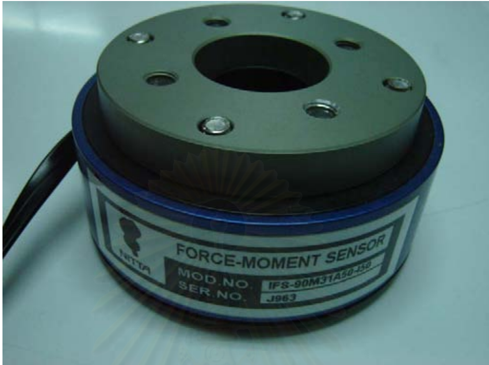
รูปที่ ๗.4 Force Sensor JR3 รุ่น IFS-90M31A50-I50
