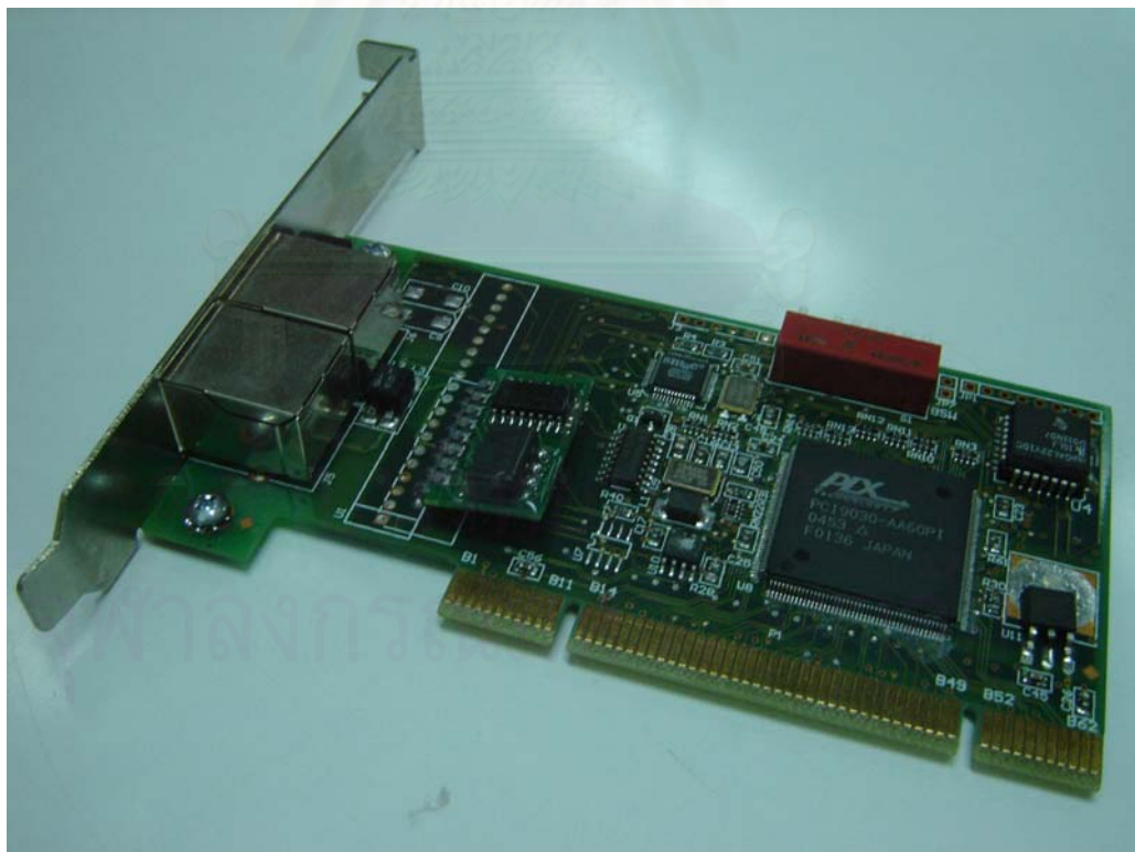
รูปที่ ข.3 ARCNET Interface cards communication board รุ่น PCI20U-4000
