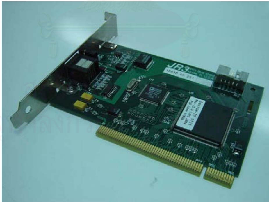
รูปที่ ๗.5 Interface cards for Force Sensor JR3
