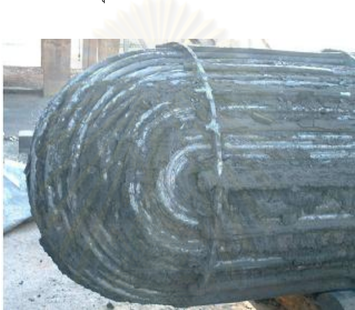
รูปที่ 2.9 รูปแสดงตัวอย่างตะกรันที่เกิดจากกระบวนการผลิตไวน์ลคอลลอไรด์โมโนเมอร์
