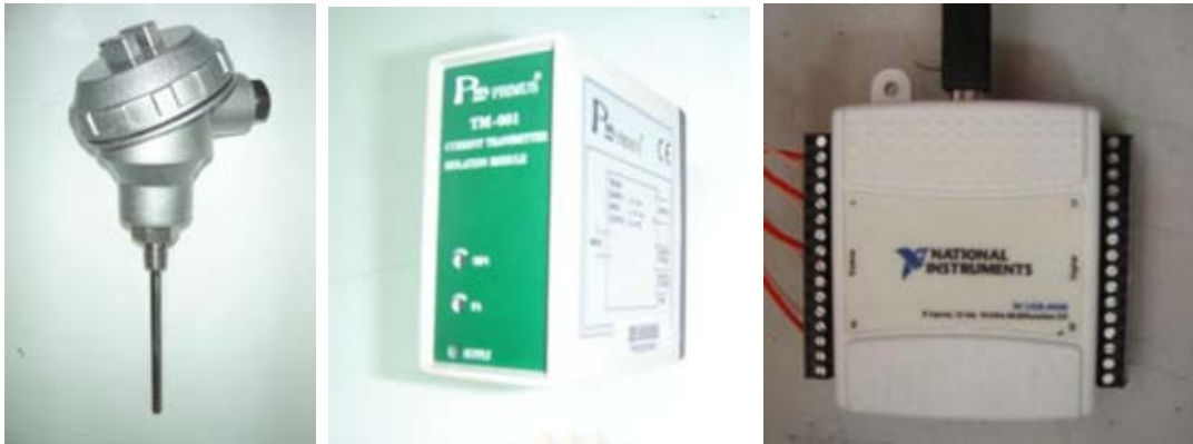
รูปที่ 4.7 แสดงเทอโมคัปเปิล (ซ้าย) ตัวแปลงสัญญาณจากกระแสเป็นโวลต์ (Current Transmitter) (กลาง) และ ตัวรับส่งข้อมูล DAQ (ขวา)
