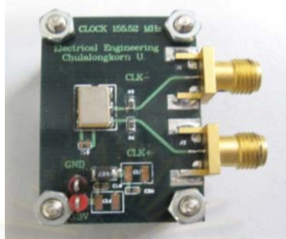
รูปที่ 3.10 วงจรสร้างสัญญาณนาฬิกาอ้างอิง โมดูล CCPD-912
