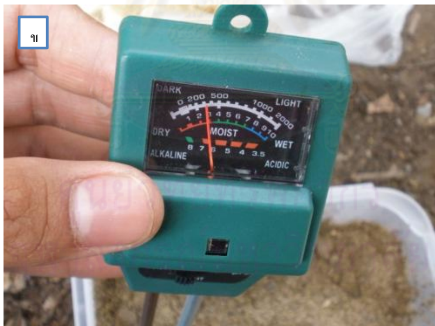
รูปที่ 16 การใช้เครื่อง Soil pH Moisture Meter วัด pH และความชื้นของดินในรัง ดินในวัสดุฟัก และดินบริเวณจุดวัดปัจจัยทางกายภาพในพื้นที่ศึกษาโดย บักกลีกลงไปในดินประมาณ 5 เซนติเมตร (ก) และผลที่ได้จากการอ่านค่าโดยเครื่องมือนี้ (ข)
