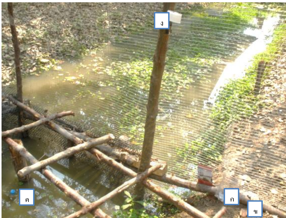
รูปที่ 3.12 จุดวัดปัจจัยทางกายภาพในพื้นที่ศึกษา โดยมีจุดวัดอุณหภูมิจนที่ผิวดิน (ก) จุดวัดอุณหภูมิจนและความชื้นของดิน (ข) จุดวัดอุณหภูมิจนของน้ำ (ค) และจุดวัดอุณหภูมิจนและความชื้นของอากาศ (ง)
