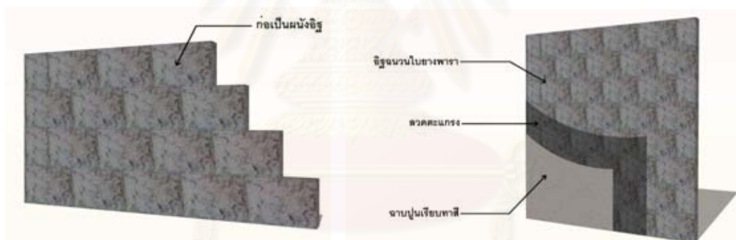
ภาพที่ 5.5 การผลิตติดตั้งฉนวนฉนวนไบบางพาราเป็นผนังอาคาร
