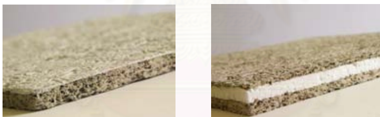
ภาพที่ 2.21 แผ่นเซลโลกรีตชนิดธรรมดา และชนิดโฟม
