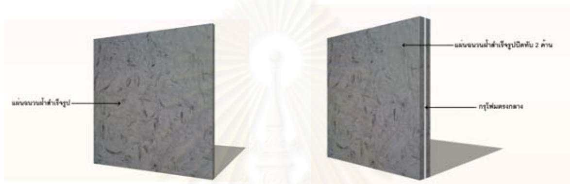
ภาพที่ 5.7 การพัฒนาแผ่นฉนวนฝ้าสำเร็จรูปโดยการกรุโพลีเอทิลีน
