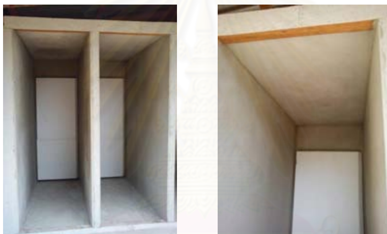
ภาพที่ 3.18 ภาพภายในห้องทดลองฉาบปูนหนา 1 ซม. ทุกด้าน
