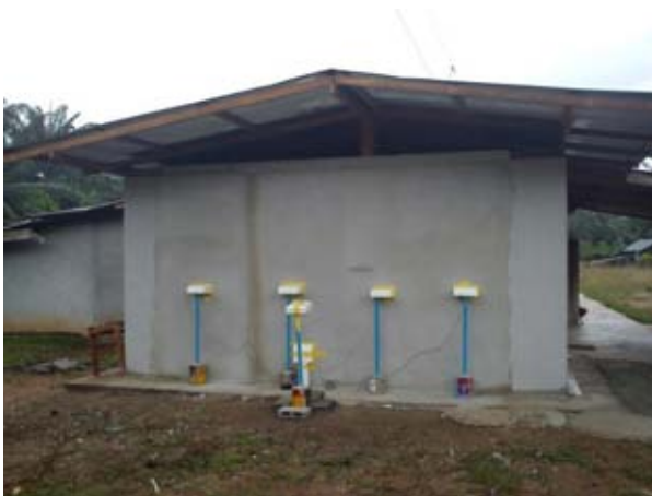
ภาพที่ 3.23 ภาพการติดตั้งเครื่องวัดอุณหภูมิ HOBOWater ภายนอกห้องทดลอง จำนวน 5 ตำแหน่ง
