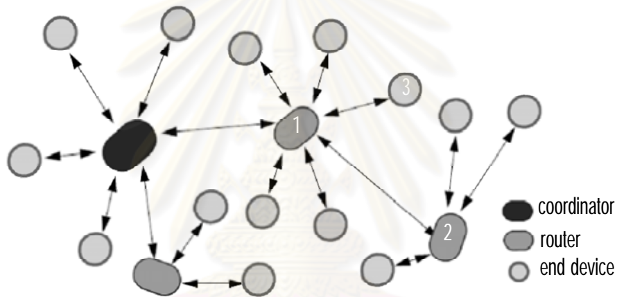
รูปที่ 2-8 Cluster Tree Network, Router ช่วยเพิ่มระยะทางการเชื่อมต่อระหว่าง End Device กับ Coordinator
