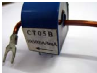
รูปที่ 3-13 หม้อแปลงกระแสกระแสที่กัด 10 แอมป์
