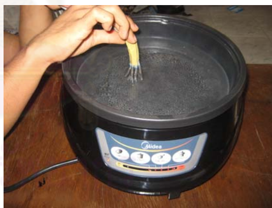
ภาพที่ 3.11 การวัดค่าความถูกต้องเครื่องมือวัดอุณหภูมิ หัว Sensor และการตรวจสอบค่าอุณหภูมิภายในห้องทดลอง
