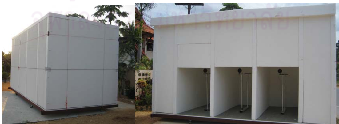
ภาพที่ 3.12 การทดสอบห้องทดลองโดยการวัดอุณหภูมิทั้ง 3 ห้อง
