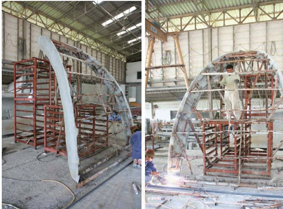
ภาพที่ 5.8 แสดงการขึ้น Model ต้นแบบ
