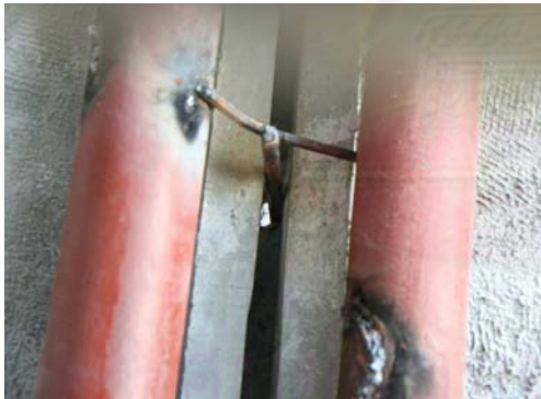
ภาพที่ 5.42 แสดงวิธีการยึดเชื่อมชิ้นงาน
