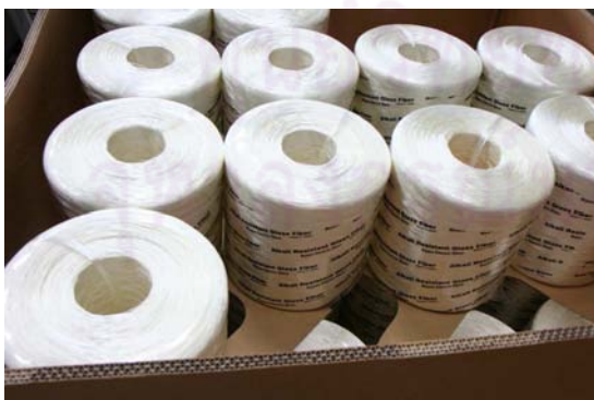
ภาพที่ 5.3 แสดงใยแก้ว ALKALI RESISTANT GLASS FIBER
