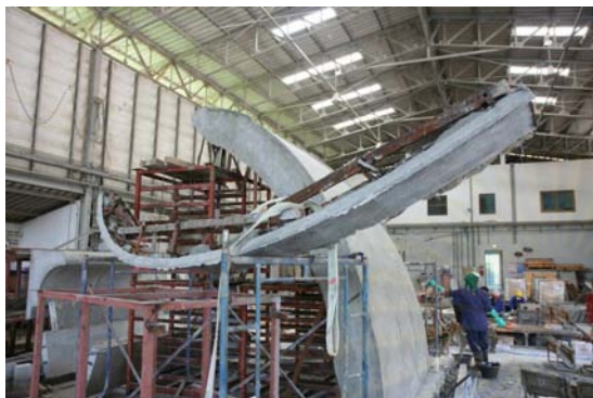
ภาพที่ 5.10 แสดงการกันขอบสำหรับแม่พิมพ์
