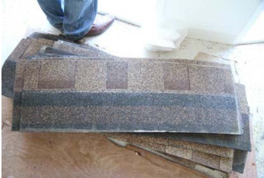
ภาพที่ 5.105 แสดงแผ่นยางมะตอยชนิด 2 ชั้น
