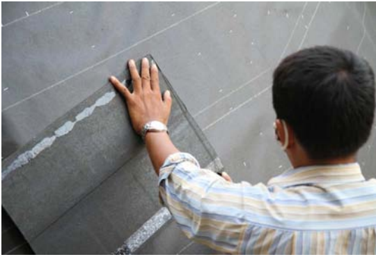
ภาพที่ 5.111 แสดงการตัดแผ่นยางให้ได้ขนาด
