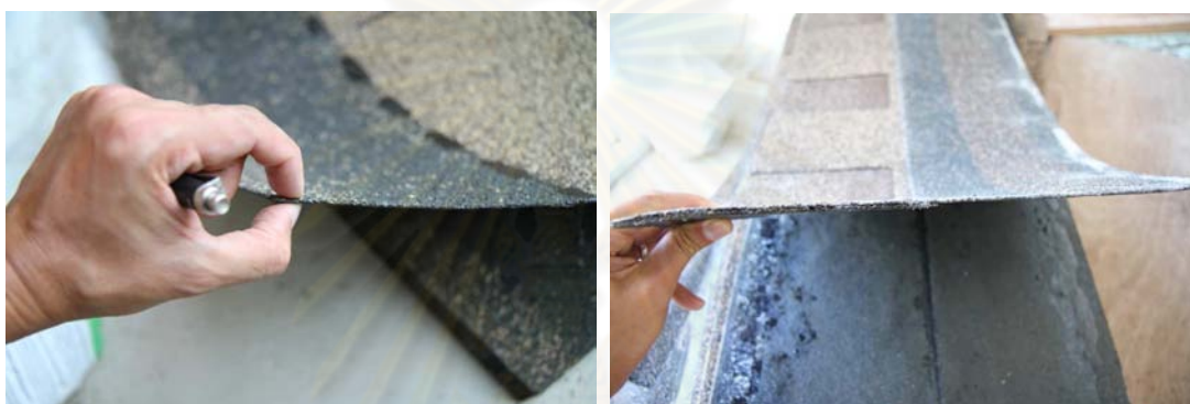
ภาพที่ 5.79 แสดงแผ่นยางมะตอย รุ่น 1 ชั้น
