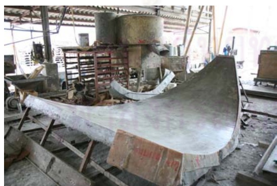
ภาพที่ 5.12 แสดงการกันขอบแม่พิมพ์
