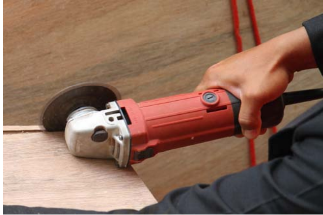
ภาพที่ 5.82 แสดงเครื่องเจียร์สำหรับตัดแผ่นไม้
