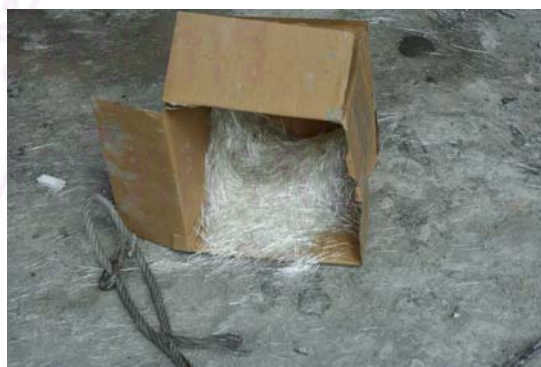
ภาพที่ 5.3 แสดงใยแก้ว ALKALI RESISTANT GLASS FIBER
