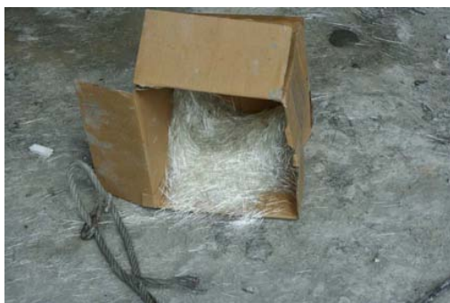
ภาพที่ 2.48 แสดง NGR ARG Fibre Chopped Strands
