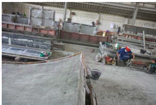
ภาพที่ 5.13 แสดงการกันขอบแม่พิมพ์
