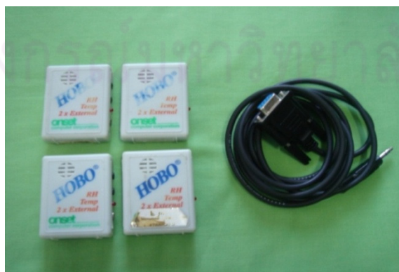
รูปที่ 3-12 เครื่องวัดอุณหภูมิและความชื้นสัมพัทธ์ ยี่ห้อ HOBO รุ่น multi channel reusable data logger
