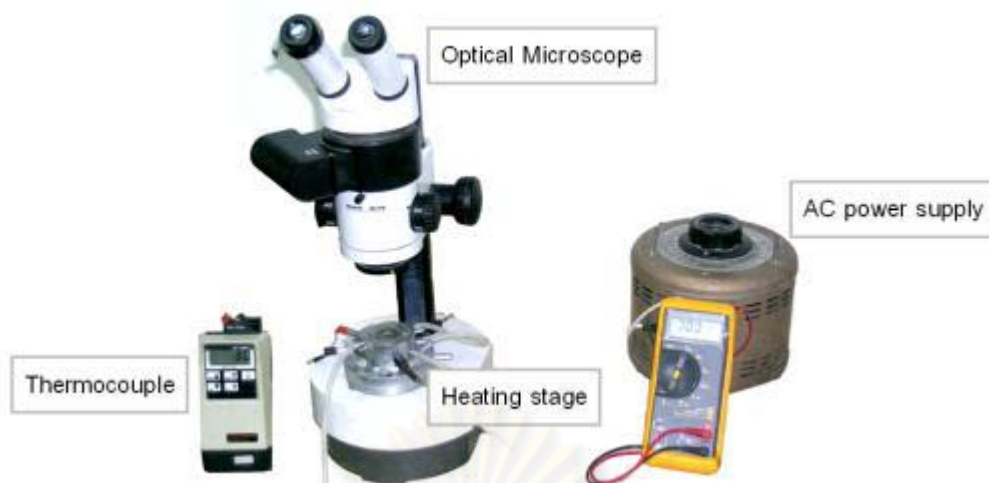
รูปที่ 3.7 อุปกรณ์ที่ใช้วิเคราะห์พฤติกรรมการหลอมตัวของเคลือบ (Heating stage microscope)
