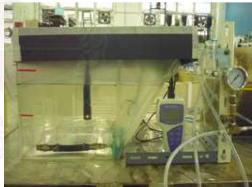
รูปที่ 3.4 ภาพแสดงการติดตั้งท่อยืดหยุ่นกับชุดอุปกรณ์วิเคราะห์ค่าสัมประสิทธิ์การถ่ายเทออกซิเจน
