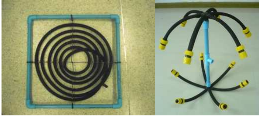
รูปที่ 3.8 ภาพแสดงตัวอย่างรูปแบบการจัดเรียงอุปกรณ์เติมอากาศชนิดท่อยัดหยุ่น
