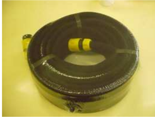
รูปที่ 3.1 ภาพแสดงท่อยืดหยุ่นที่ใช้เป็นอุปกรณ์เติมอากาศ
