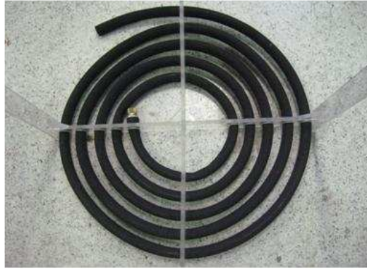
รูปที่ 2.26 ภาพแสดงรูปแบบการจัดเรียงท่อยึดหยุ่นเป็นวงกลมรูปก้นหอย
