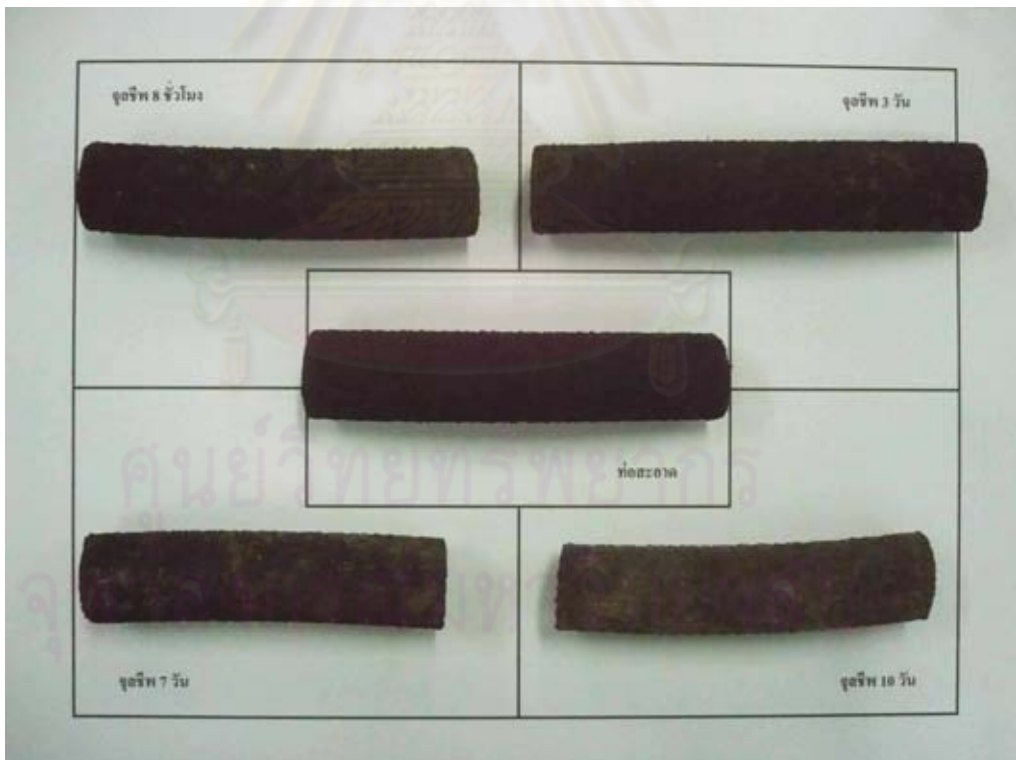
รูปที่ 4.48 ภาพถ่ายท่อยึดหยุนที่อุดตันด้วยเซลล์จุลชีพ
