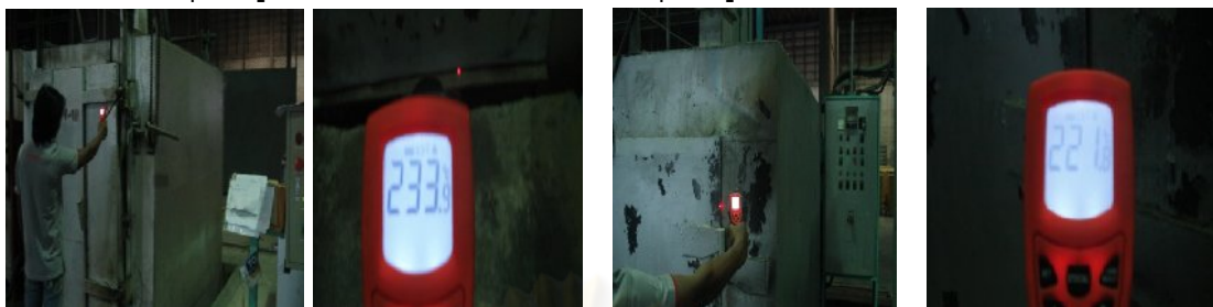
รูปที่ 4.20 ตรวจวัดอุณหภูมิผนังและขอบประตูเตาอบก่อนทำการปรับปรุง
