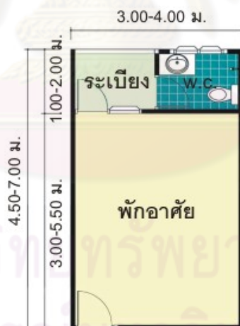
ภาพที่ 4.9 แสดงรูปการวางแบบแปลนที่นิยมในบ้านเช่าส่วนตัวบริเวณชุมชนสวนผัก
