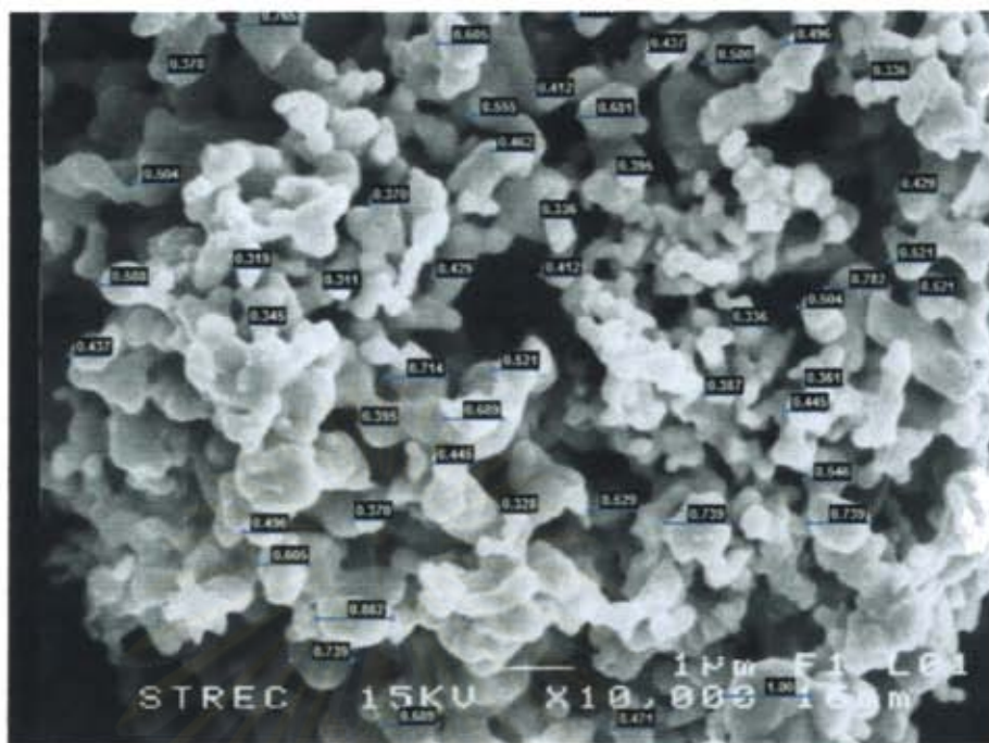
รูปที่ ค.14 แสดงการวัดขนาดอนุภาคจากภาพ SEM ของผงที่ผลิตจากการใช้ซิลเวอร์ซัลเฟตที่มี (ขนาดเล็ก)รีดิคซ์ด้วยกลีเซอรอลผสมโซเดียมไฮดรอกไซด์ที่มีอัตราส่วนโมล \text{Ag}_2\text{SO}_4:\text{NaOH} เท่ากับ 1:2 นาน 2 ชม. ที่ความเร็วในการกวนที่ 500 rpm ที่อุณหภูมิ 150\text{ }^\circ\text{C}
