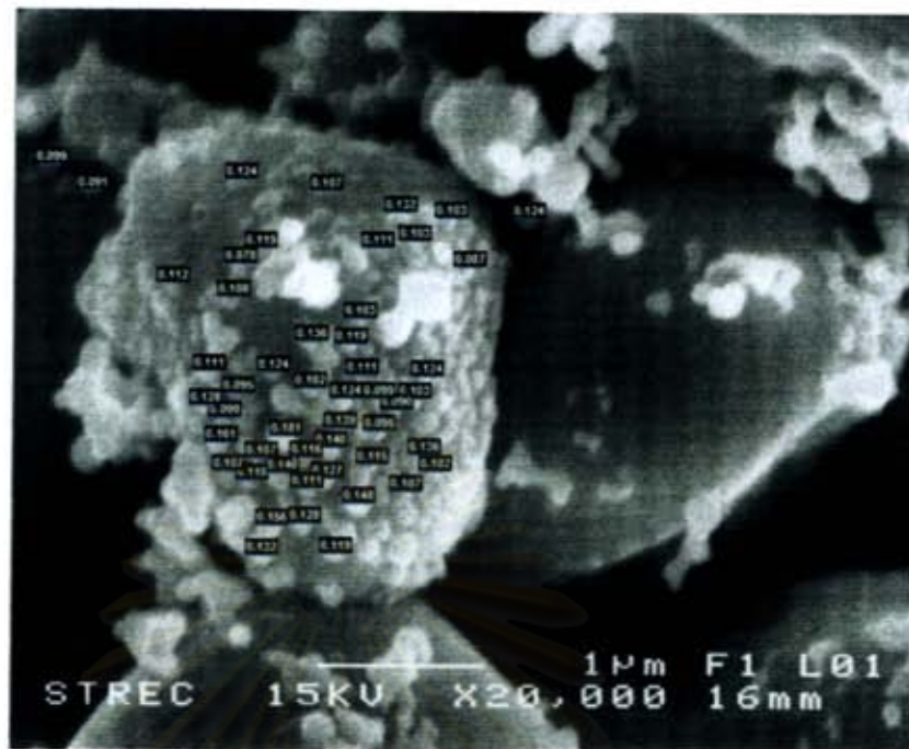
รูปที่ ค.2 แสดงการวัดขนาดอนุภาคจากภาพ SEM ของผงที่ผลิตจากการใช้ซิลเวอร์ซัลเฟตที่มี (ขนาดใหญ่)รีดิวิซ์ด้วยกลีเซอรอลเป็นเวลา 2 ชม.ที่ความเร็วในการกวนที่500rpmที่อุณหภูมิ125°C
