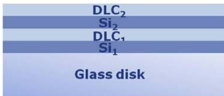
รูปที่ 7.16 ลักษณะของดิสก์ที่มี 5 ชั้นที่จะใช้ในการ Optimize sensitivity ในการวัด Flying height โดยการเปลี่ยนแปลงความหนาของชั้นฟิล์ม Si_1 , DLC_1 , Si_2 และ DLC_2
