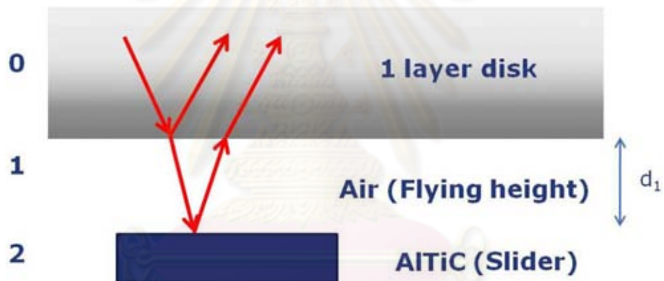
รูปที่ 6.13 แบบจำลองในการคำนวณที่เครื่องวัด Flying height ใช้ในการสร้าง Theory curve ซึ่งจะพิจารณาดิสก์เสมือนมีชั้นเดียว
