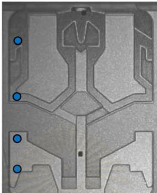
รูปที่ 7.31 ตำแหน่งบน ABS ที่ใช้ทำการวัด Flying height และความเข้มแสงเพื่อทดสอบ Sensitivity (จากบนไปล่าง TAE_1, TAE_2, TAE_3 และ TAE_4)
