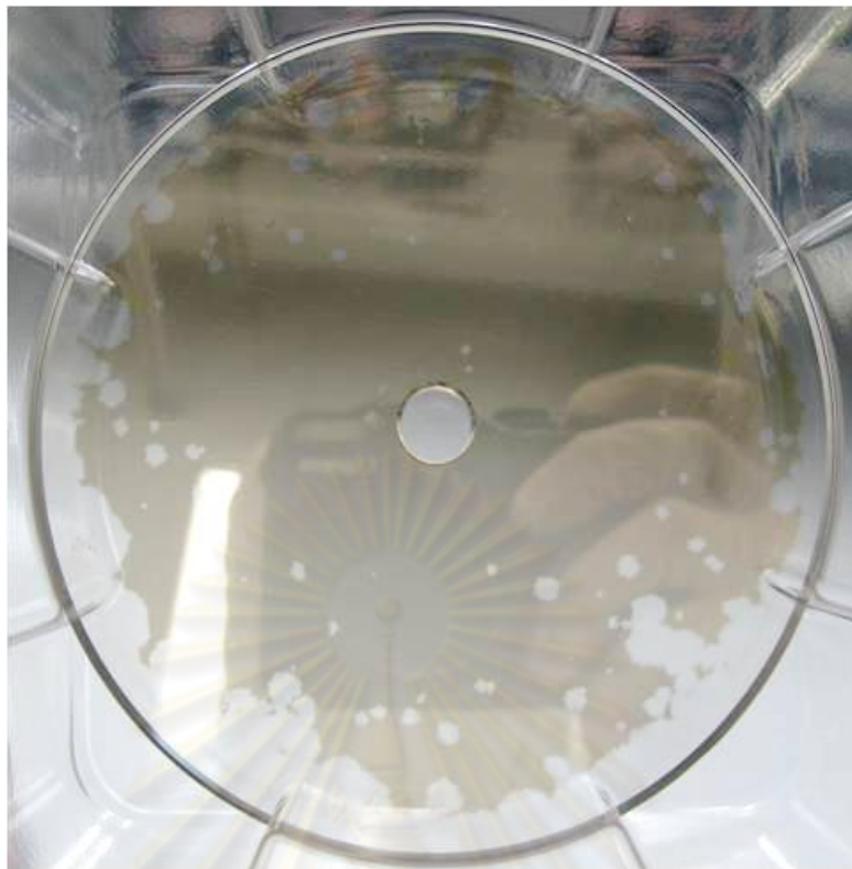
รูปที่ 7.14 ดิสก์ที่มีความหนา DLC 88 นาโนเมตรซึ่งเกิดการหลุดลอกของฟิล์ม DLC ซึ่งบริเวณที่เกิดการหลุดลอกของ DLC เมื่อเซ็ดฟิล์ม DLC ออกจะลักษณะใสเหมือนจานแก้ว
