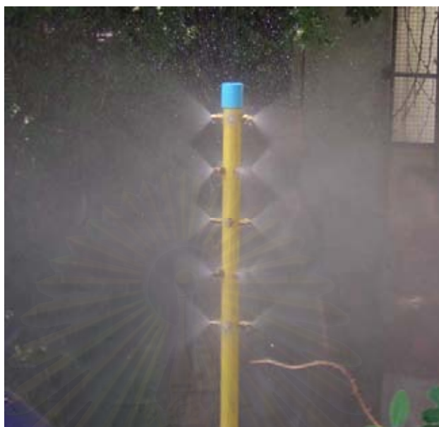
รูปที่ 4.6 การซ้อนทับกันของหยดละอองน้ำที่ออกมาจากสเปคเตอร์ 20 หัวฉีด
