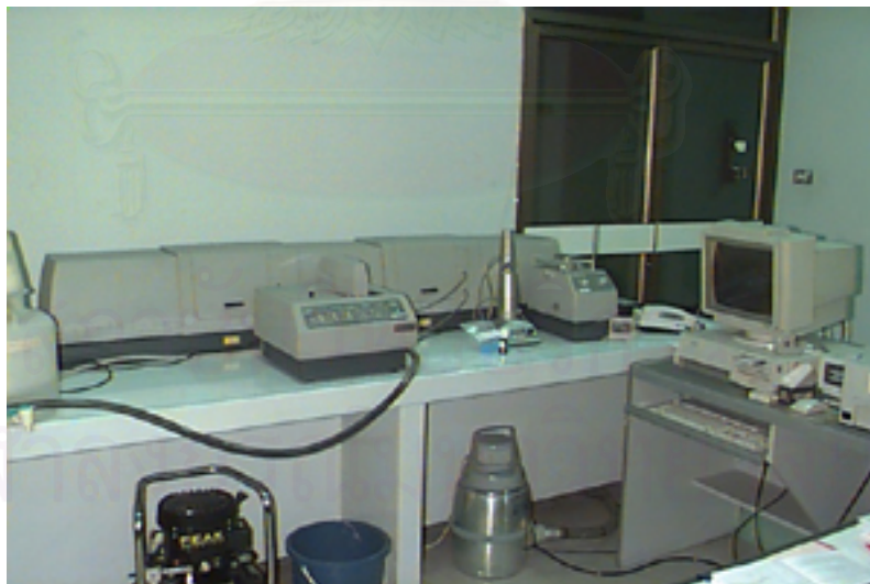
รูปที่ 3.1 เครื่องวิเคราะห์การแจกแจงขนาดอนุภาค ( Particle Size Analyzer)
