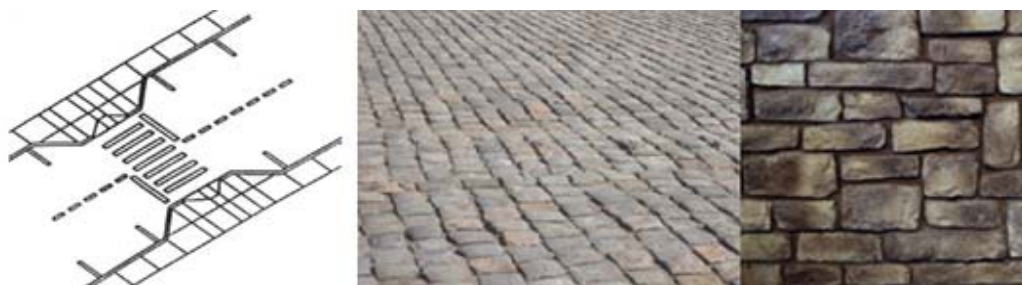
ภาพที่ 7-03 การสร้างความปลอดภัยให้ผู้เดินเท้าด้วยการยื่นทางสัญจรบางส่วนเข้าไปในพื้นที่ถนน (ซ้าย) และการเปลี่ยนผิววัสดุเพื่อแยกประเภทของทางเดินเท้า (ขวา) (ที่มา: โดยผู้วิจัย, 2551)
