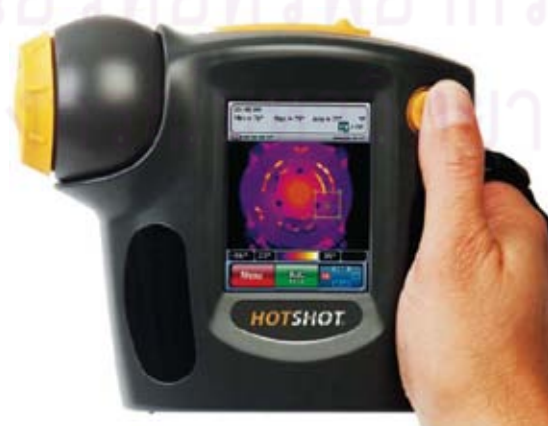
รูปที่ 5.5 Thermal imaging camera
