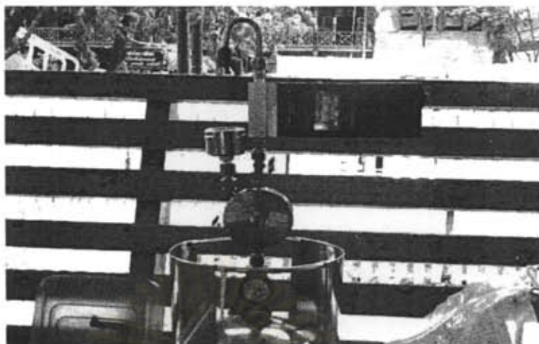
รูปที่ ข-2 ถัง Canister ต่อกับ Pressure gage, Flow meter และ Passive sampler
