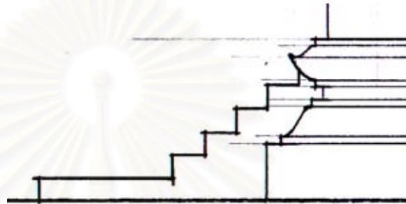
ภาพที่ 4-11 และ ภาพลายเส้นที่ 4-18 ส่วนฐานอาสามวัดหลวง ก่ออิฐเป็นบัวแฉกชั้นปากพาน
